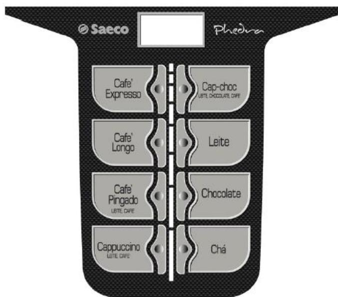
O layout padrão para esta máquina é o ao lado, porem pode-se personalizar utilizando as bebidas que deseja. Para começar a utilização da máquina recomenda-se utilizar o padrão pois ela já vem pré programada desta forma e quando estiver familiarizado com a programação personalizar como deseja.
