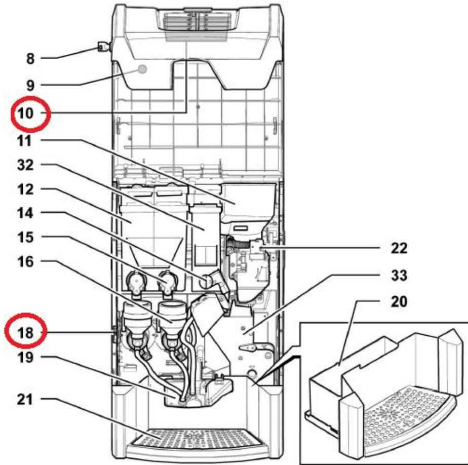
Para acessar a programação é preciso acionar a tecla no interior da máquina, para isso é necessário fazer com que ela trabalhe com a porta aberta, usando a chave de serviço azul (imagem abaixo) que vem dentro do kit da máquina (envelope branco) colocar a chave de serviço no interrupto de segurança (indicado pelo numero 18), localizado na porta conforme segue imagem ao lado.
